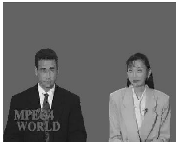
(d) Fractal/SA-DCT (30.31dB at 0.26bpp)
